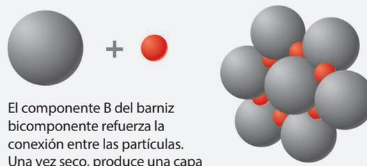
El componente B del barniz bicomponente refuerza la conexión entre las partículas. Una vez seco, produce una capa cerrada y resistente.
