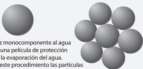
Un barniz monocomponente al agua produce una película de protección gracias a la evaporación del agua. Durante este procedimiento las partículas se van acercando las unas a las otras hasta crear una película muy cerrada. Por consiguiente el barniz tendrá un rendimiento de media fuerza.
